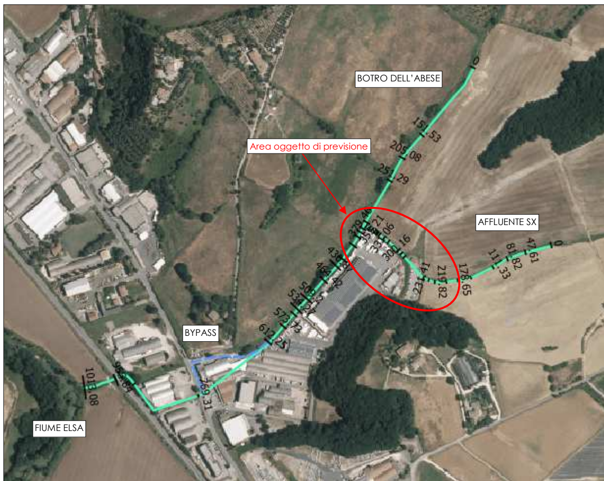
Fig. 21 – Schema del modello idraulico monodimensionale d'alveo del Botro dell'Abese (compreso bypass) ed affluente sinistro
